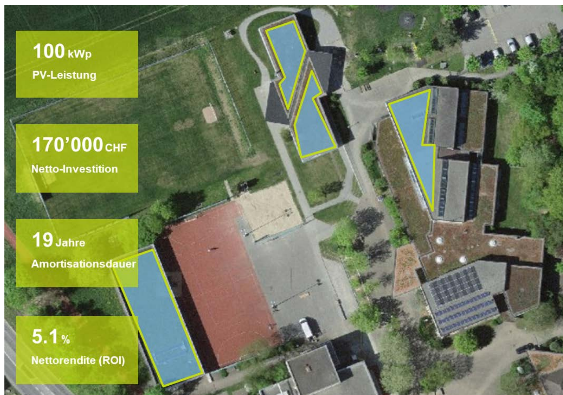
Abbildung 3: Sicht auf das Dach der Schulanlage in Rubigen und die wichtigsten Kennzahlen. Blau eingezeichnet ist die Fläche, welche mit Solarmodulen belegt werden könnte. (Quelle: Google Maps).
